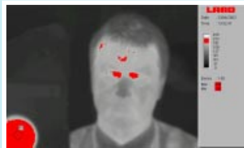
Imagen correspondiente a la función Isoterms, que nos muestra los puntos calientes de acuerdo a las temperaturas fijadas en el software.
